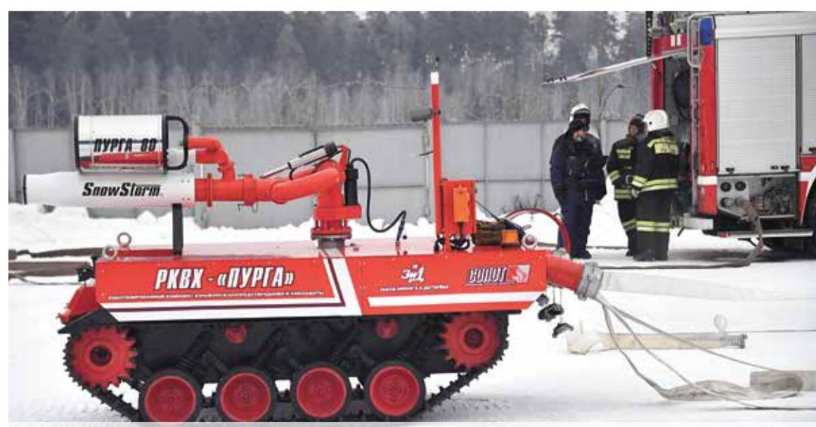
Комплекс взрывопожаропредотвращения и химзащиты «Пурга-RK-M40D»
